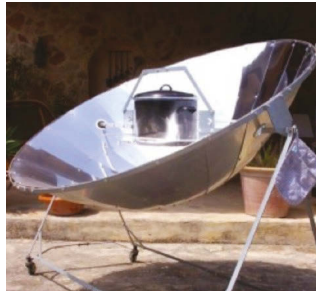
Sumber: komporsurya.blogspot.com Gambar 4.28 Komporsurya. Tandai di mana masakan dimasak. Mengapa permukaan pemantul panas matahari mengkilap? Mengapa melengkung?
